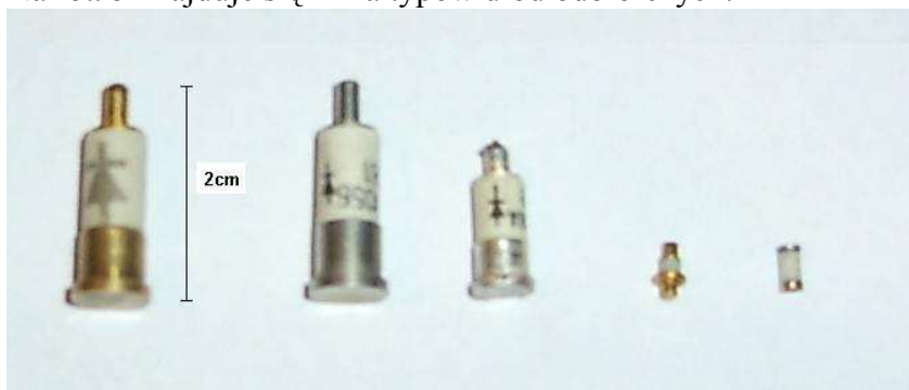
fot.5. Krystaliczne diody odbiorcze (mieszające). Od lewej: 1N23C, D405B, D406A, BADB14B
