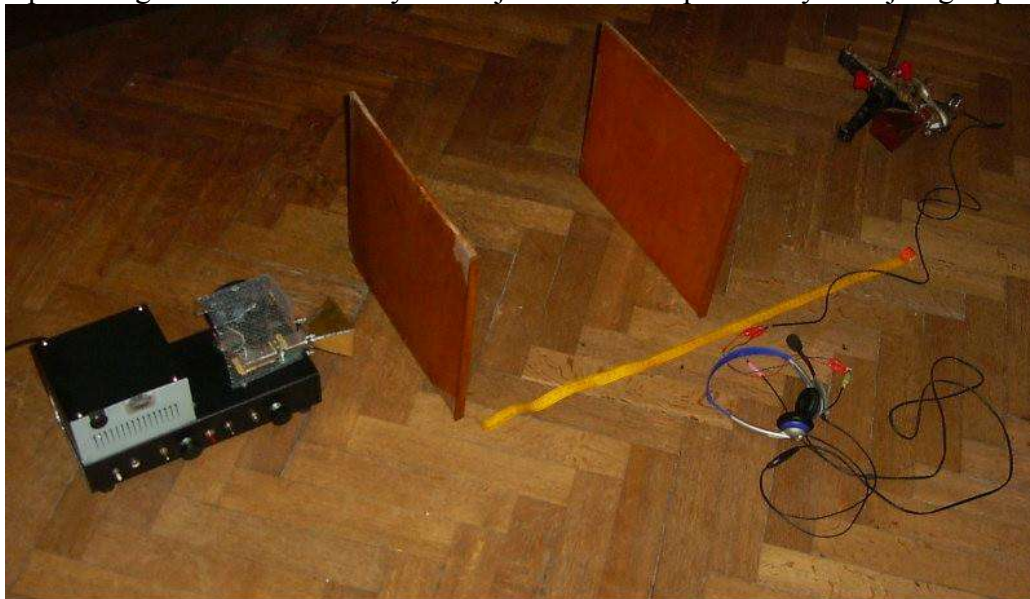
fot.9. Zestaw do pomiaru długości fali
