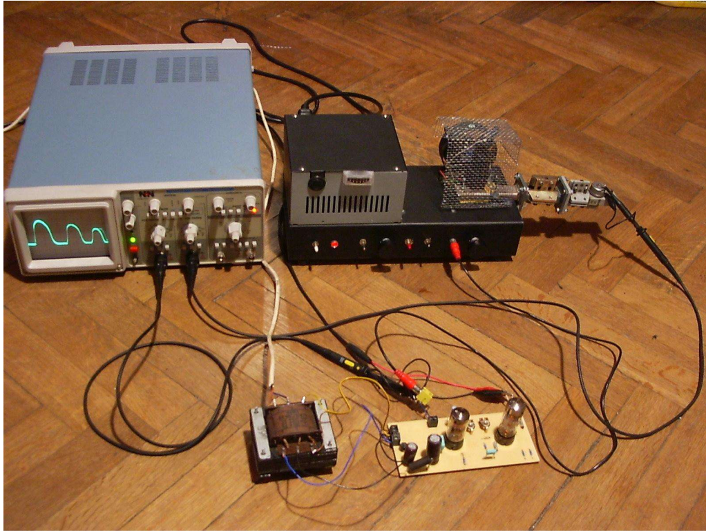
fot. 14. Układ do oscyloskopowego zdjęmowania charakterystyki P_{wy}=f(U_{rf}) klustronu
